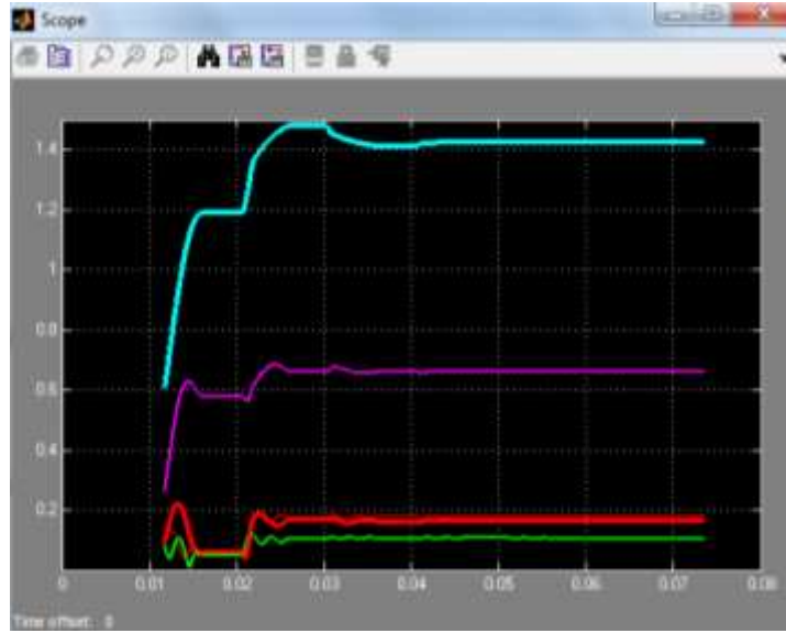
Şəkil 4. Tacın kompensasiya olunmuş cərəyanının 1-7-ci harmonikalarının amplitudlarının dəyişmə əyriyələri
