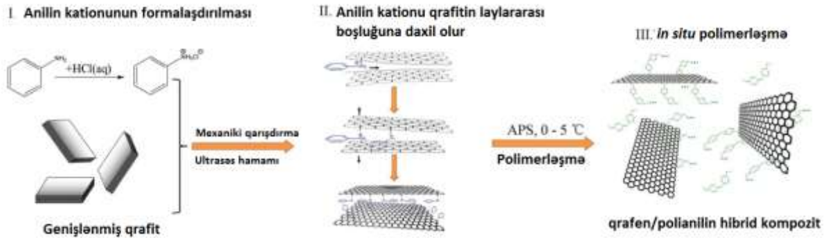
Şəkil 4. Qrafen/polianilin hibrid kompozitin sintez sxemi [24]
