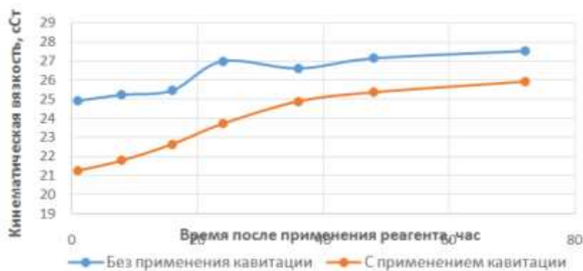
Рис.3. Изменение кинематической вязкости нефти с месторождения Шыхбаги в зависимости от времени под влиянием химического реагента и кавитации
